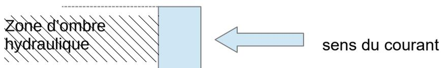
Zone située à l'arrière d'un bâtiment ou ouvrage existant par rapport au sens du courant. Le fait d'implanter un bâtiment dans l'ombre hydraulique d'un autre bâtiment limite son effet d'obstacle à l'écoulement.
