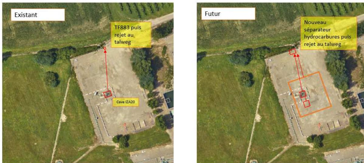
*Note : Schéma de principe. La dalle aura une dimension d'environ 1000m<sup>2</sup>, sa géométrie sera adaptée en fonction de l'implantation des équipements du rig de forage qui sera sélectionné.*
